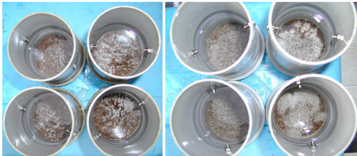
Abb. 4-1: Sedimentfallen nach 3,5 Wochen Expositionsdauer im Cospudener See (links: RCS5 – Hafenbereich, rechts: RCS 3 – Südbereich)
